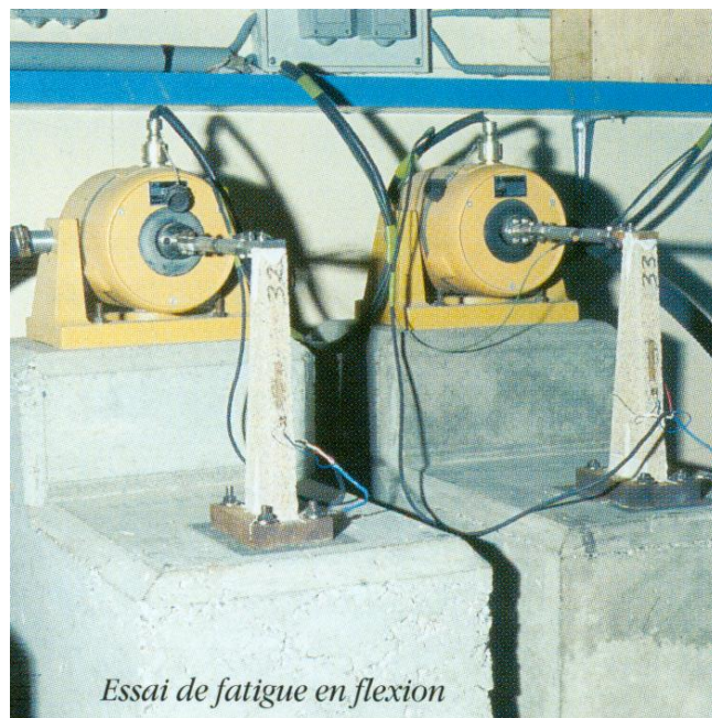
Rysunek 3.23. Badanie zginania wspornikowego belki trapezowej, wg [5].
