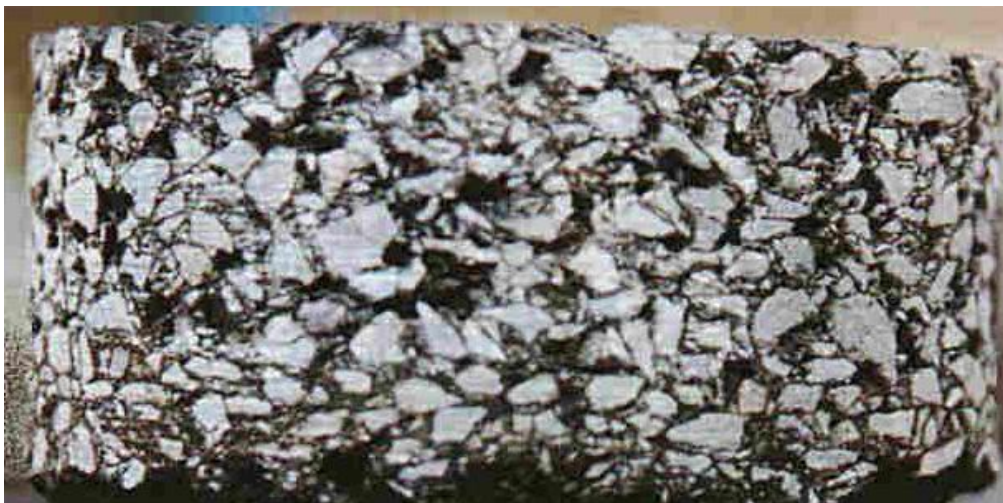
Rys. 6.22. Warstwa CRL, asfaltowa o 20% zawartości wolnych przestrzeni
